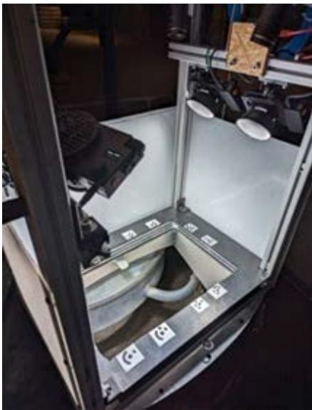
AUFNAHME DES MISCHVORGANGS MIT EINEM STEREOKAMERASYSTEM
